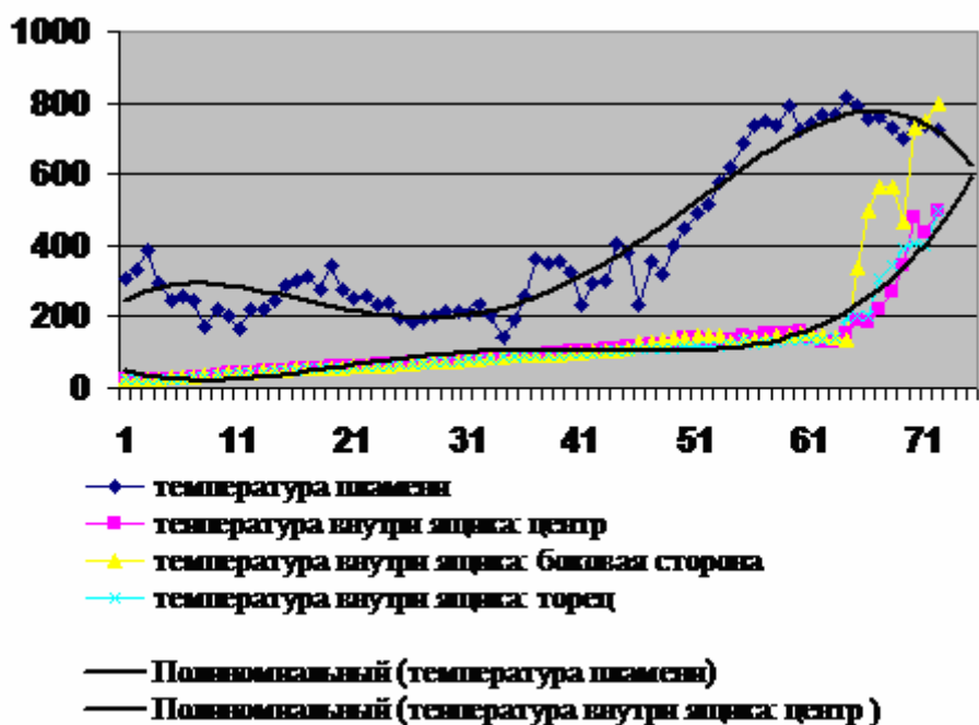
Рис. 3. Исследование температурного режима деревянного ящика обработанного огнезащитной краской «Аккорд» при внешнем термическом воздействии
