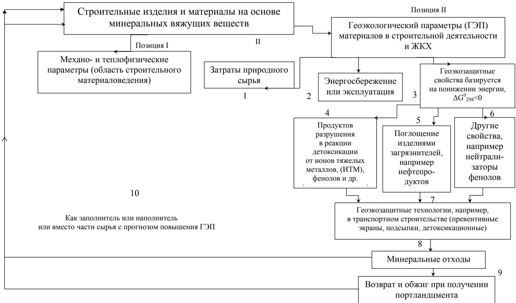
Рис. Схема замкнутого цикла цементных материалов в геозооэкономических строительных технологиях с реализацией самопроизвольных процессов на базе понижения свободной энергии системы
