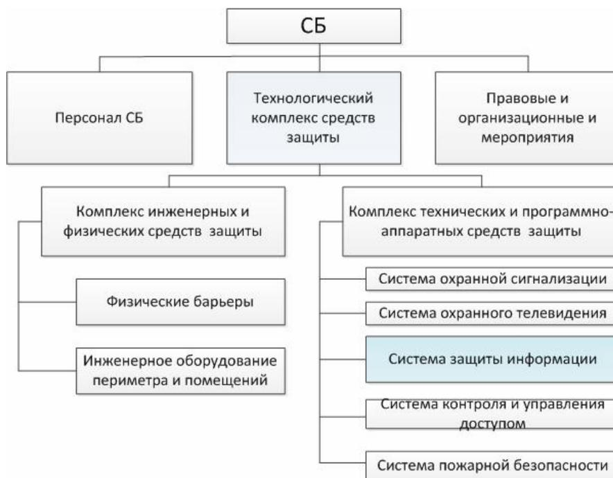
Рис. 4. Обобщенная структурная схема СБ
