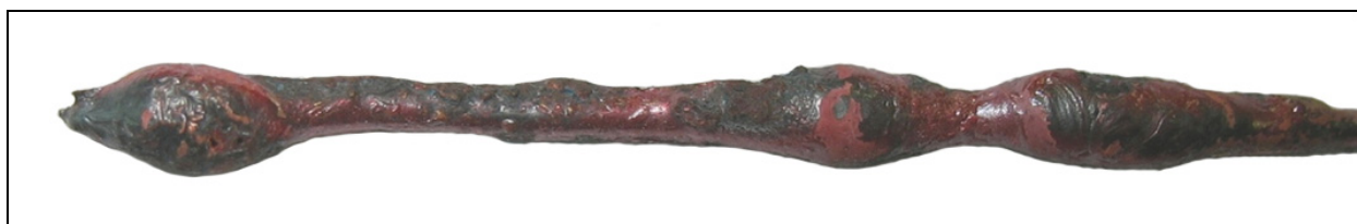
Рис. 2. Утолщения и утончения, образовавшиеся на поверхности медного проводника в результате протекания токовой перегрузки кратностью свыше 4÷5
