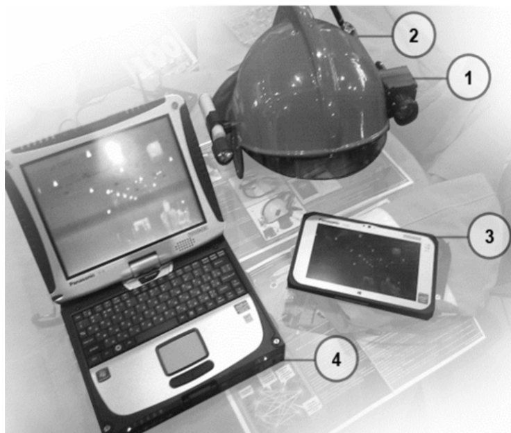
Рис. 1. Мобильная тепловизионная система «Шлем-камера»
