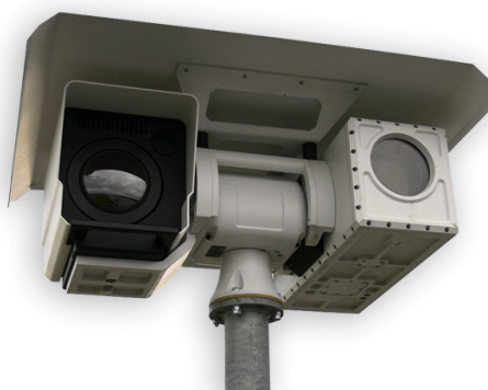
Рис. 3. Двухсенсорная система оптико-электронного наблюдения «КИВЕР»
