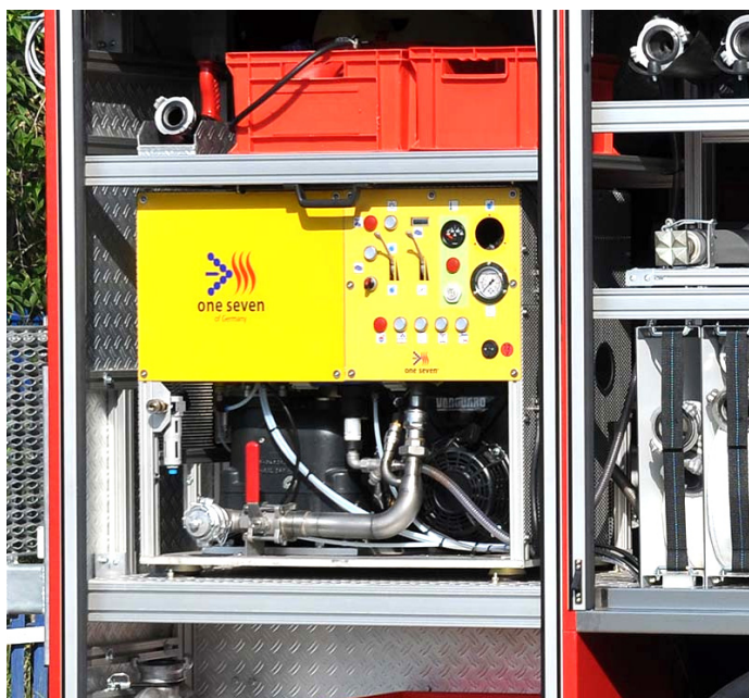
Рис. 3. Установка пенного тушения OS 1200NE в отсеке кузова пожарной автоцистерны АЦ-3,0-40(4308) ООО «Приоритет»
