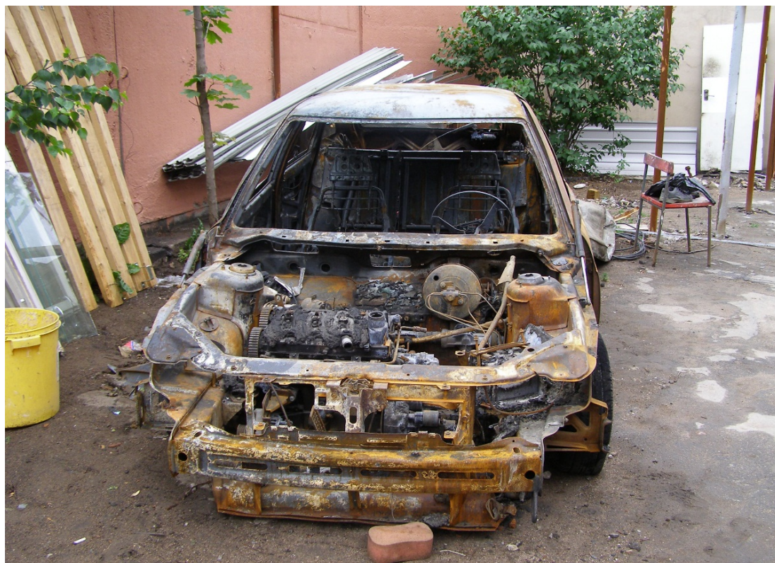
Рис. 1. Пример пожара в моторном отсеке при аварийном режиме топливной системы
