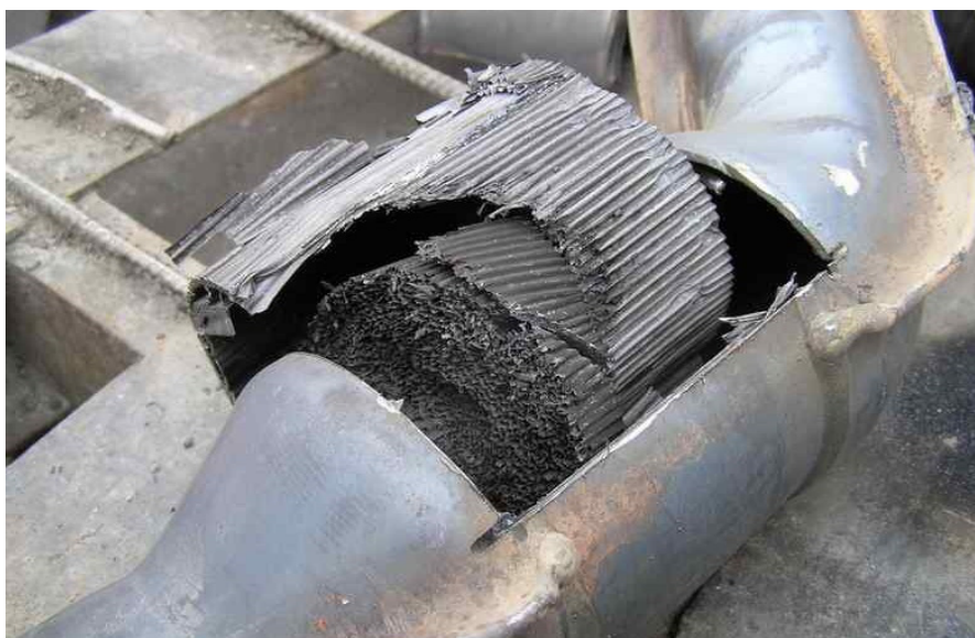
Рис. 1. Фотография оплавленного металлического блока-носителя КН при аварийных режимах работы автомобильного двигателя внутреннего сгорания
