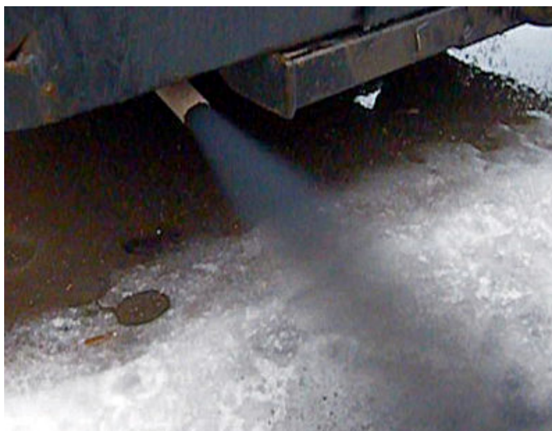
Рис. 3. Шлейф плотно черного дыма – косвенный «свидетель» аварийных экологически и пожарно-опасных для КН режимов работы двигателя. Такие черные окрашенности отработавших газов характерны для измеряемых значений оптической плотности (дымности) в диапазоне 95–98 % [2]
