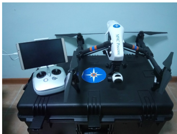
Рис. 6. Комплекс оперативного мультиспектрального мониторинга Арнега-ДСТИ на базе DJI Inspire 1
