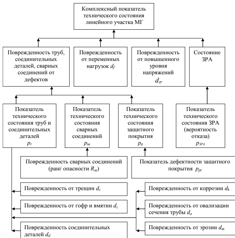
Рис. 8. Структурная схема определения комплексного показателя технического состояния линейного участка МГ по результатам ВТД и других обследований (ЗРА – запорно-регулируемая арматура)
