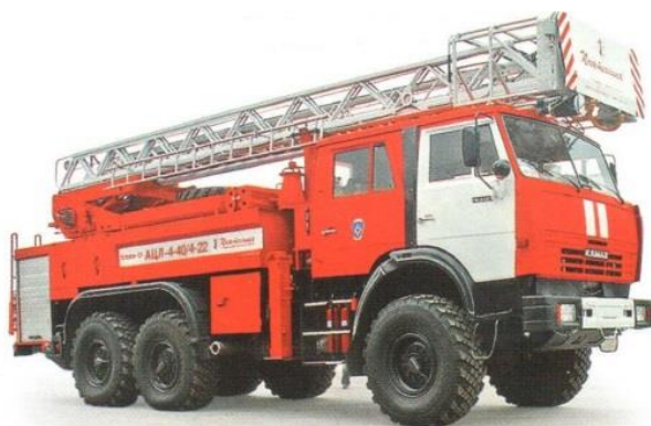
Рис. 8. Пожарная автоцистерна с лестницей АЦЛ-4-40/4-22 (43118)ПМ-634А
