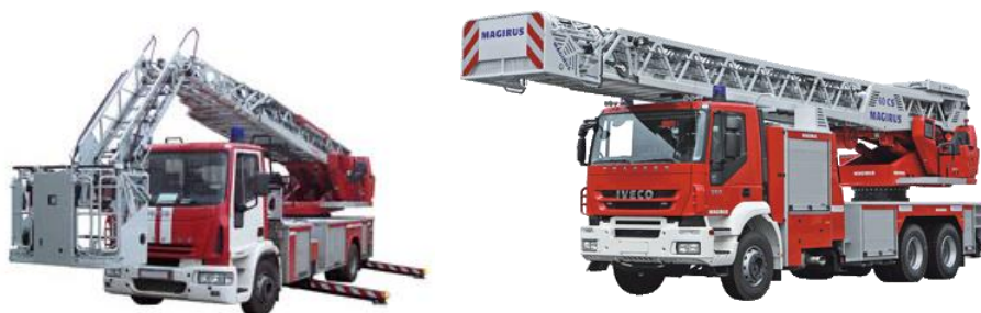
Рис. 9. Пожарные автолестницы Iveko Magirus: DLK 23-12 CS GL-T (слева) и DLK 55 CS (справа)
