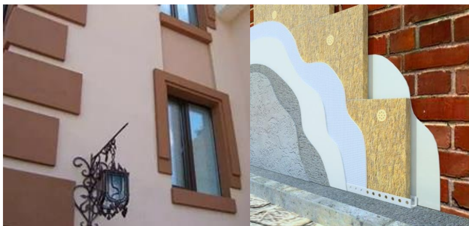
Рис. 1. ФТКС с наружными штукатурными слоями
