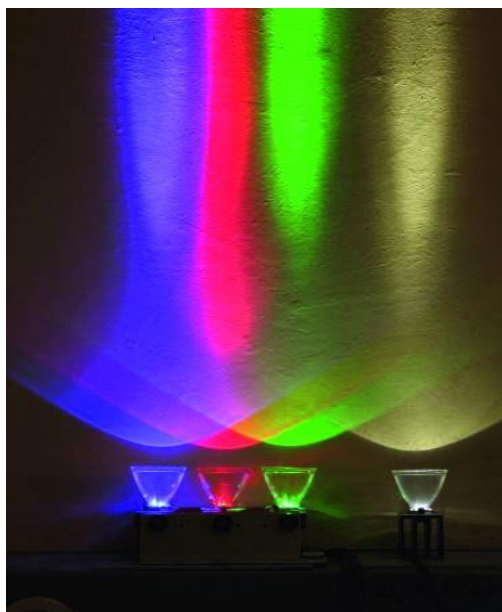
Рис. 2. Сверхъяркие светодиоды с силой света 10–15 тыс. кандел
